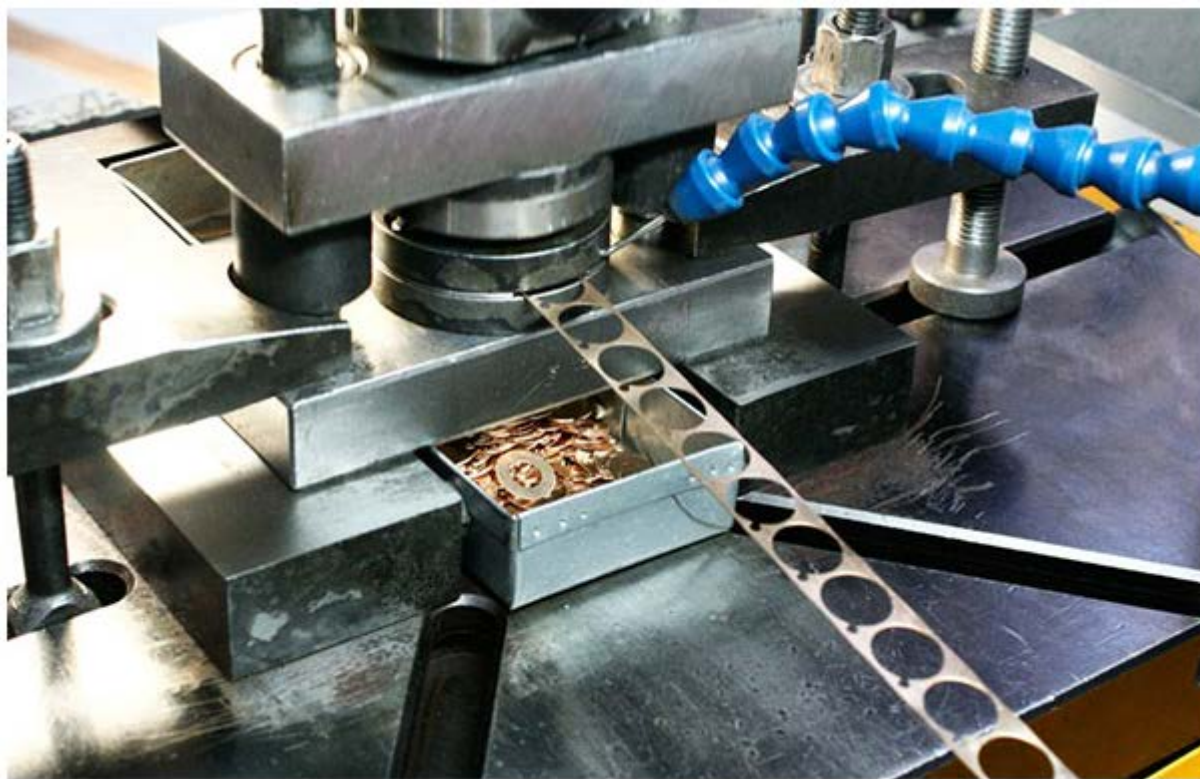
2-сурет - Суық қалыптау арқылы әр түрлі бөлшектерді дайындау сәті
